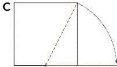
Cuarto paso: dibujar el rectángulo hasta el lado extendido
